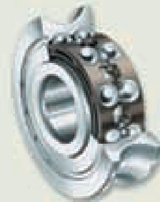
Профилированный фиксирующий ходовой ролик: двухрядный радиально-упорный шарикоподшипник с профилированным наружным кольцом не требует технического обслуживания
