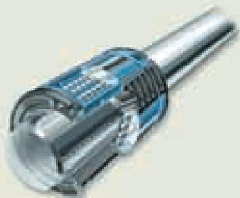
С высокой грузоподъемностью: шарикоподшипники линейного перемещения тяжелой серии обеспечивают эффективную компенсацию перекосов за счет четырех самоустанавливающихся сегментов – размерные серии от 12 до 50
