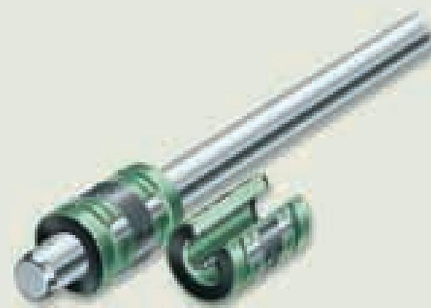
Экономия и долговечность: линейные шарикоподшипники легкой серии, размерные серии от 12 до 50, интегрированные смазочные полости, компенсация угловых перекосов до  $\pm 30'$
