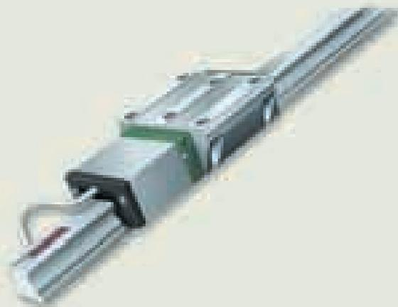
Для простоты манипулирования: интегрированная в каретку измерительная система с электронным блоком обработки результатов для шариковых направляющих с абсолютным цифровым или инкрементальным датчиком, размерные серии от 20 до 45
