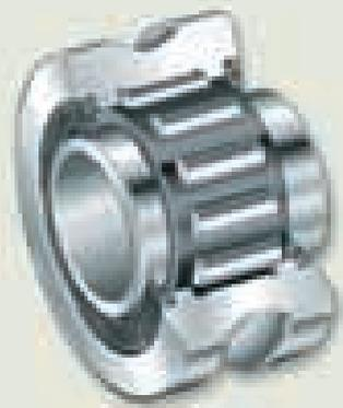
Профилированный плавающий ходовой ролик: игольчатый подшипник с профилированным наружным кольцом и внутренним кольцом, перемещаемым в осевом направлении, применяется вместе с направляющими рельсами
